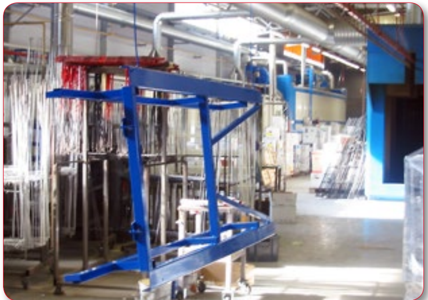
Kaikki kalusteet jauhemaalataan tai kuumasinkitään.
